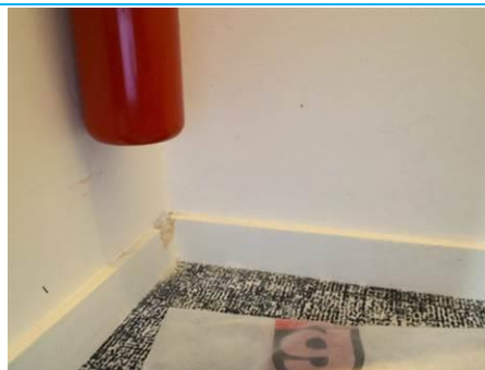
Matériaux : ZPSO-041 Prélèvement : P210 Description : Colle de carrelage en plinthes Localisation : 4ème étage - 402 Extincteurs Résultat : Absence d'amiante
