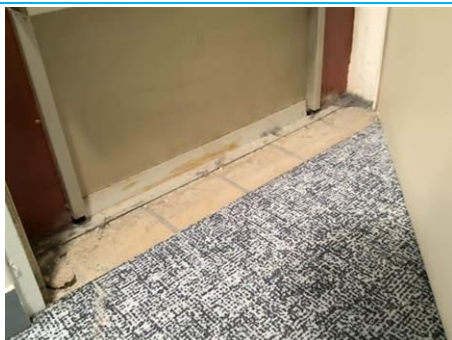
Matériaux : ZPSO-047 Prélèvement : P218 Description : Colle de carrelage beige au sol Localisation : 2ème étage - 201 Circulation noyau Résultat : Absence d'amiante
