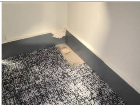
Matériaux : ZPSO-047 Prélèvement : P209 Description : Colle de carrelage beige au sol Localisation : 4ème étage - 401 Circulation noyau Résultat : Absence d'amiante
