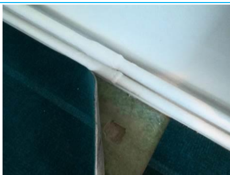
Matériaux : ZPSO-033 Prélèvement : P119 Description : Revêtement de sol vert + colle + ragréage (sous moquette) Localisation : 2ème étage - 212 Com CRE Résultat : Absence d'amiante
