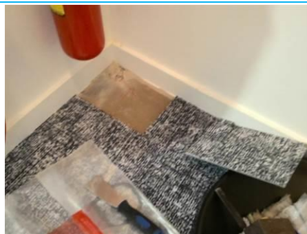
Matériaux : ZPSO-047 Prélèvement : P193 Description : Colle de carrelage beige au sol Localisation : 7ème étage - 702 Extincteurs Résultat : Absence d'amiante
