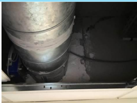
Matériaux : ZPSO-006 Prélèvement : P194 Description : Plénum: Enduit plâtre lissé sur béton Localisation : 7ème étage - 701 Dégagement Résultat : Absence d'amiante
