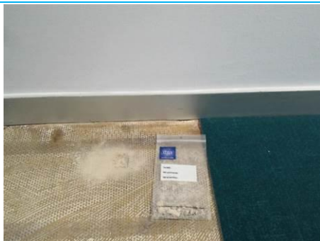
Matériaux : ZPSO-029 Prélèvement : P102 Description : Colle jaune + ragréage sous revêtement Localisation : 4ème étage - 421 Circulation Résultat : Absence d'amiante
